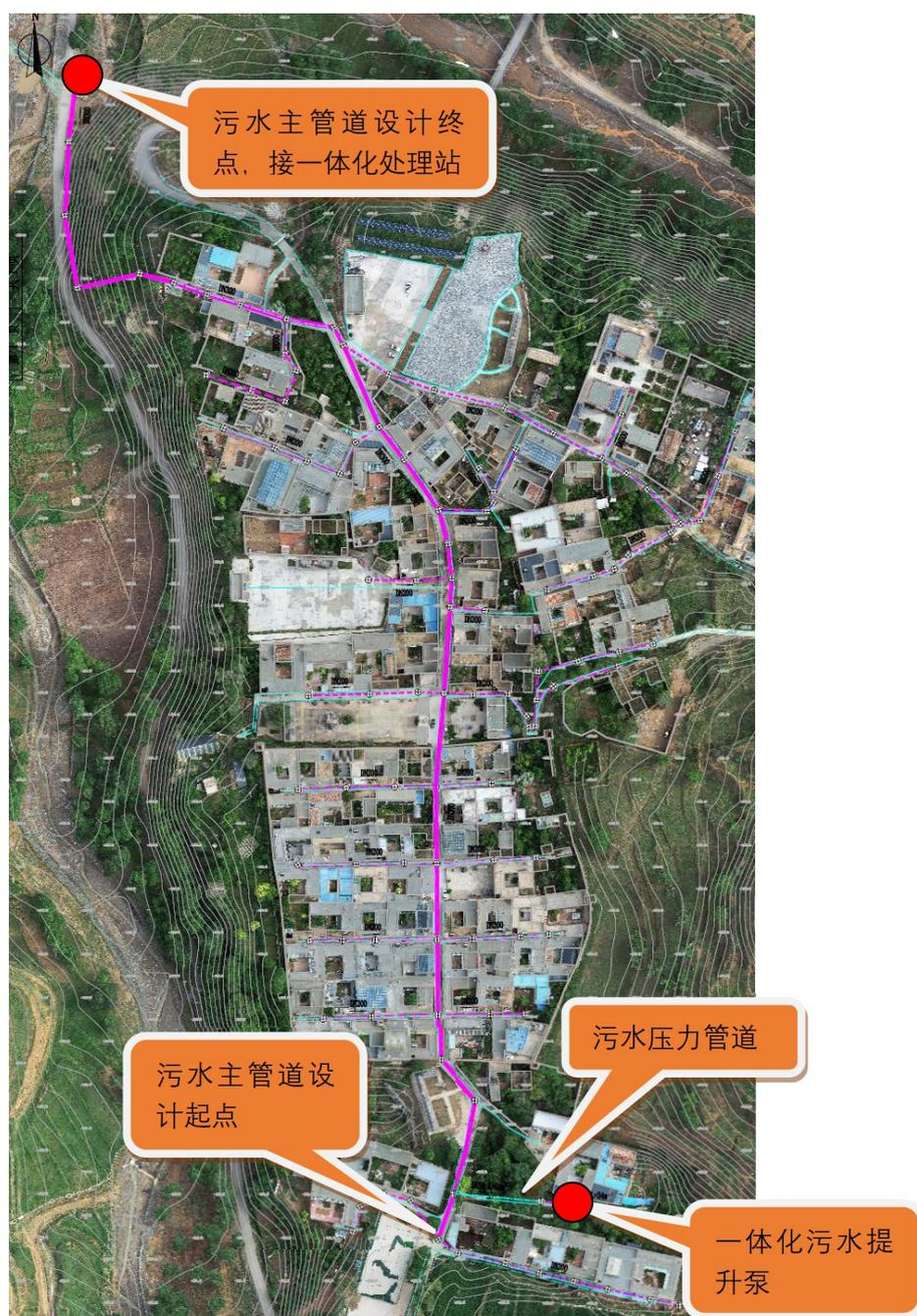
图 4.4.1 方案一 污水主管道位置示意图
