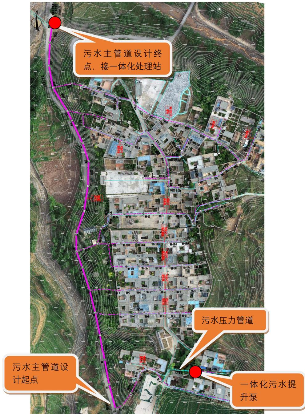
图 4.4.2 方案二 污水主管道位置示意图
