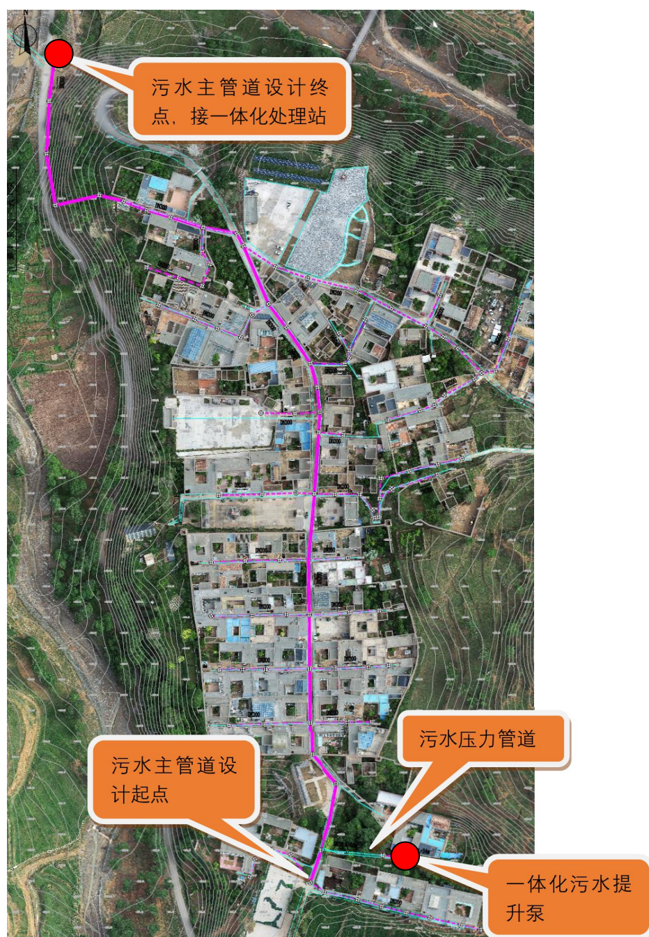
图 4.4.1 方案一 污水主管道位置示意图
