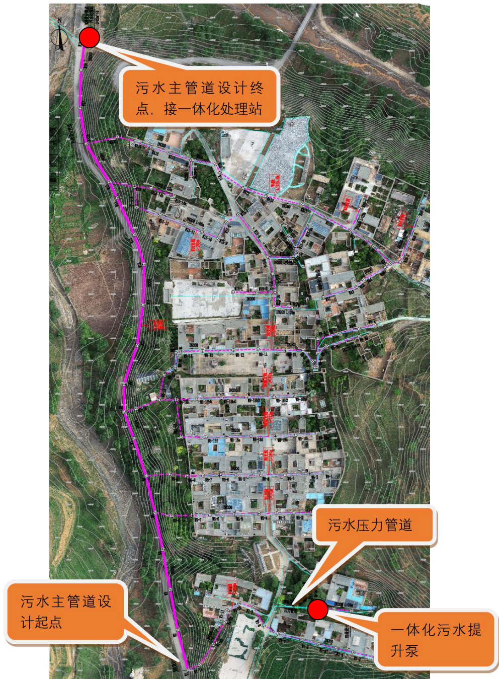
图 4.4.2 方案二 污水主管道位置示意图
